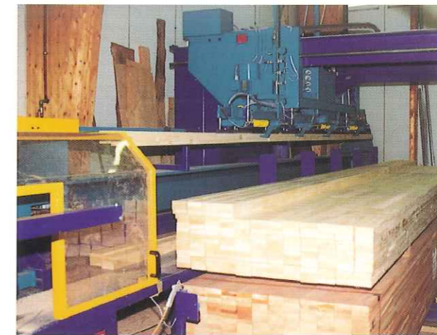
Alimentación automática de la tronzadora por dispositivo elevador de vacío.
