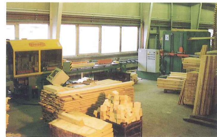
Un descargador en combinación con apilador automático.
